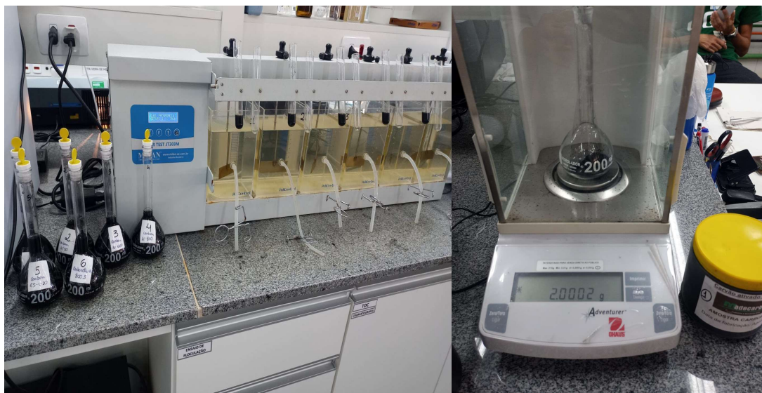
Figura 3: Amostras de carvões preparadas a 5% para adição no teste de jarro.
