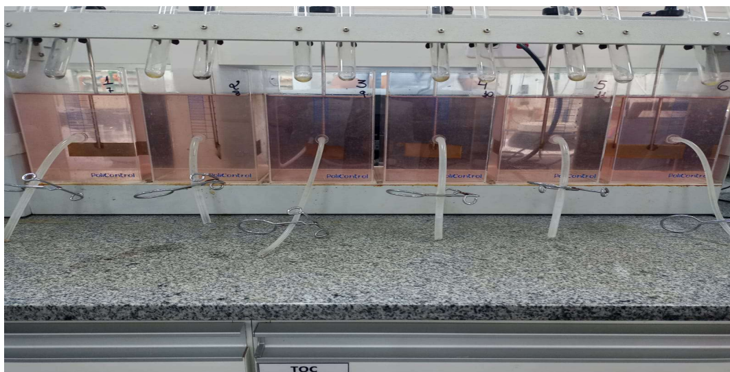
Figura 4: Aplicação de permanganato de potássio na água de estudo.
