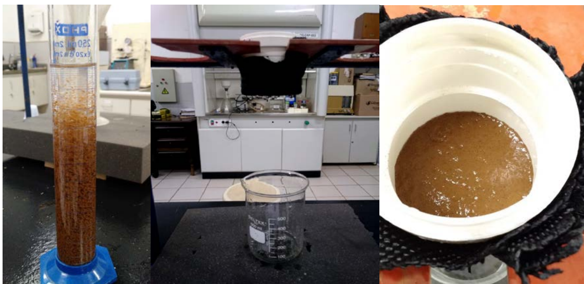
Figura 3 - Instalação de bancada de desaguamento em Geotecido.
