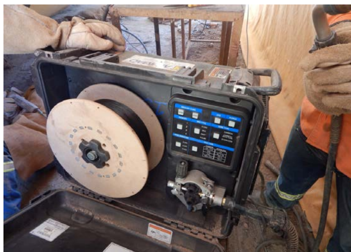
Equipamento de soldagem FCAW
