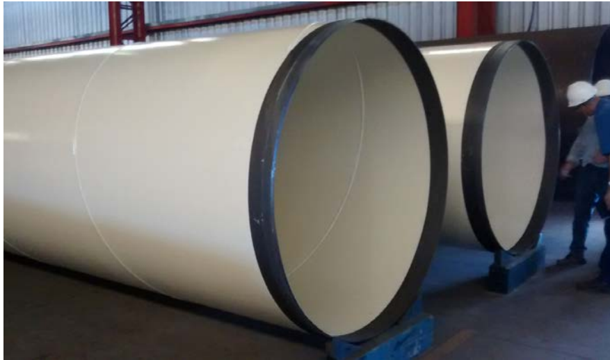
Vista geral dos tubos revestidos interna e externamente
