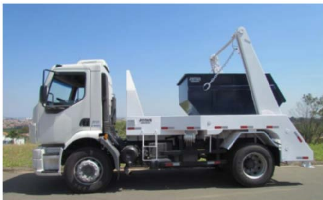
Figura 3: Caminhão poliguindaste com caçamba tipo Dempster de 7 m 3 Fonte: Mercado Hidráulico (2016)
