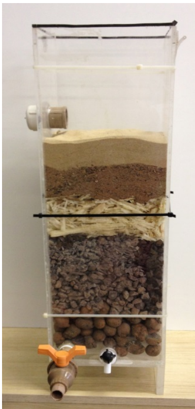
Figura 3: Filtro em escala piloto com as camadas adotadas dispostas conforme Tabela 1.
