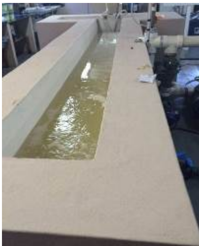
(c) – Canal de alvenaria utilizado nos experimentos
