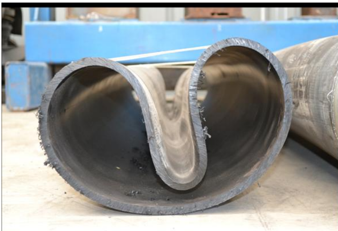
Foto 02 – Tubulação deformada em “C” pronta para inserção.
