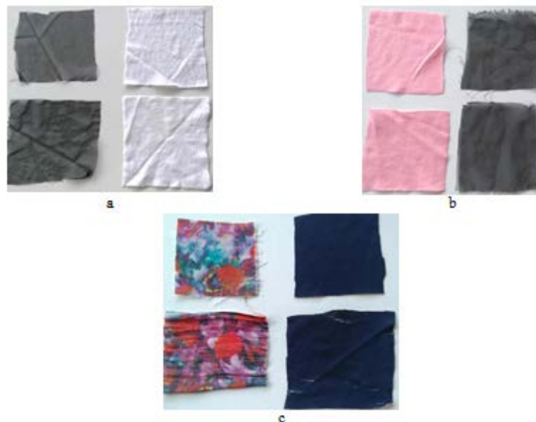
Figura 3: Comparação entre os tecidos sintéticos antes e depois do ensaio de degradação em solo: (a) Tecido plano e malha de 100% Poliamida; (b) Tecido plano e malha de 100% Poliéster; (c) Tecido plano e malha de 50% algodão/50% poliéster.
