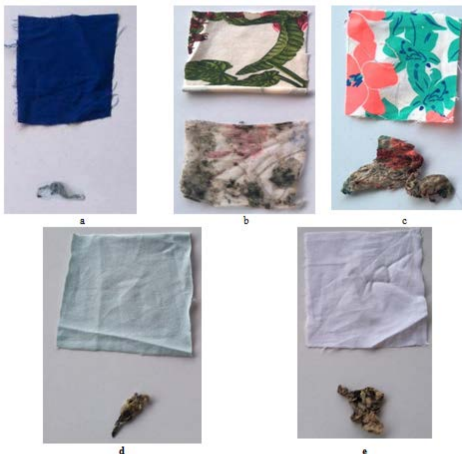
Figura 1: Comparativo entre os tecidos celulósicos antes e depois da degradação em solo. (a) Tecido plano de viscose/elastano; (b) Tecido de malha de viscose/elastano; (c) Tecido plano de algodão/elastano; (d) Tecido de malha de 100% algodão; (e) Tecido plano de 100% algodão.
