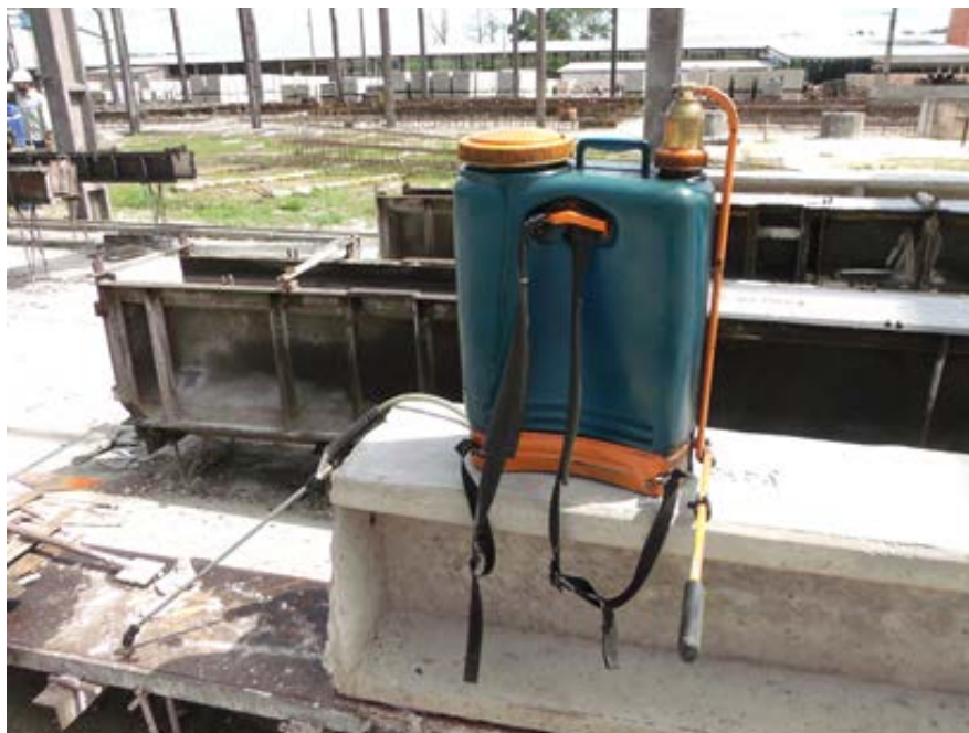
Figura 11: Equipamento utilizado para untar a forma com óleo reaproveitado
