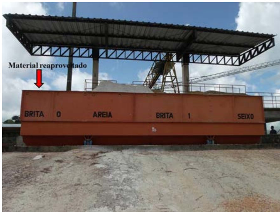
Figura 05: Insumos da produção de concreto com a utilização do resíduo de concreto britado
