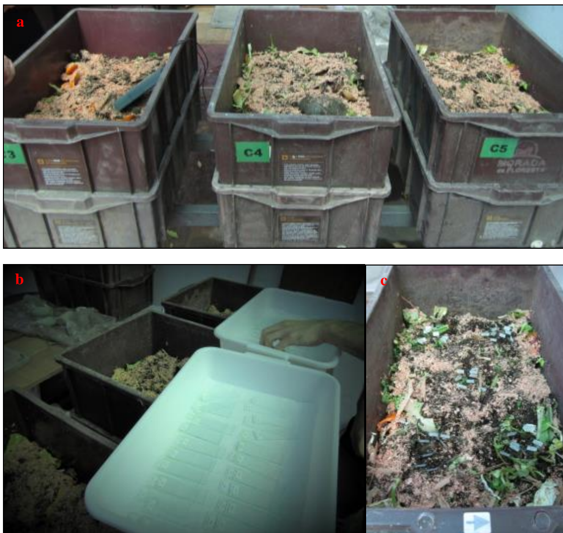
Figura 1: Montagem das composteiras (a). Identificação das lâminas para inserção nas composteiras (b). Acomodação das lâminas identificadas nas composteiras (c).
