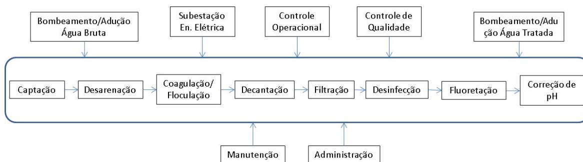
Figura 2: Exemplo de fluxograma de processos de uma Estação de Tratamento de Água (próprio autor).
