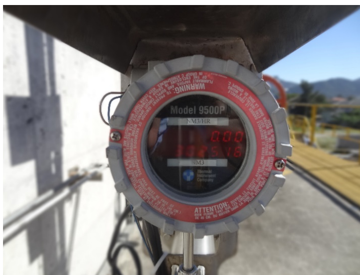
Figura 7 - Equipamento para quantificar a vazão de biogás no reator
