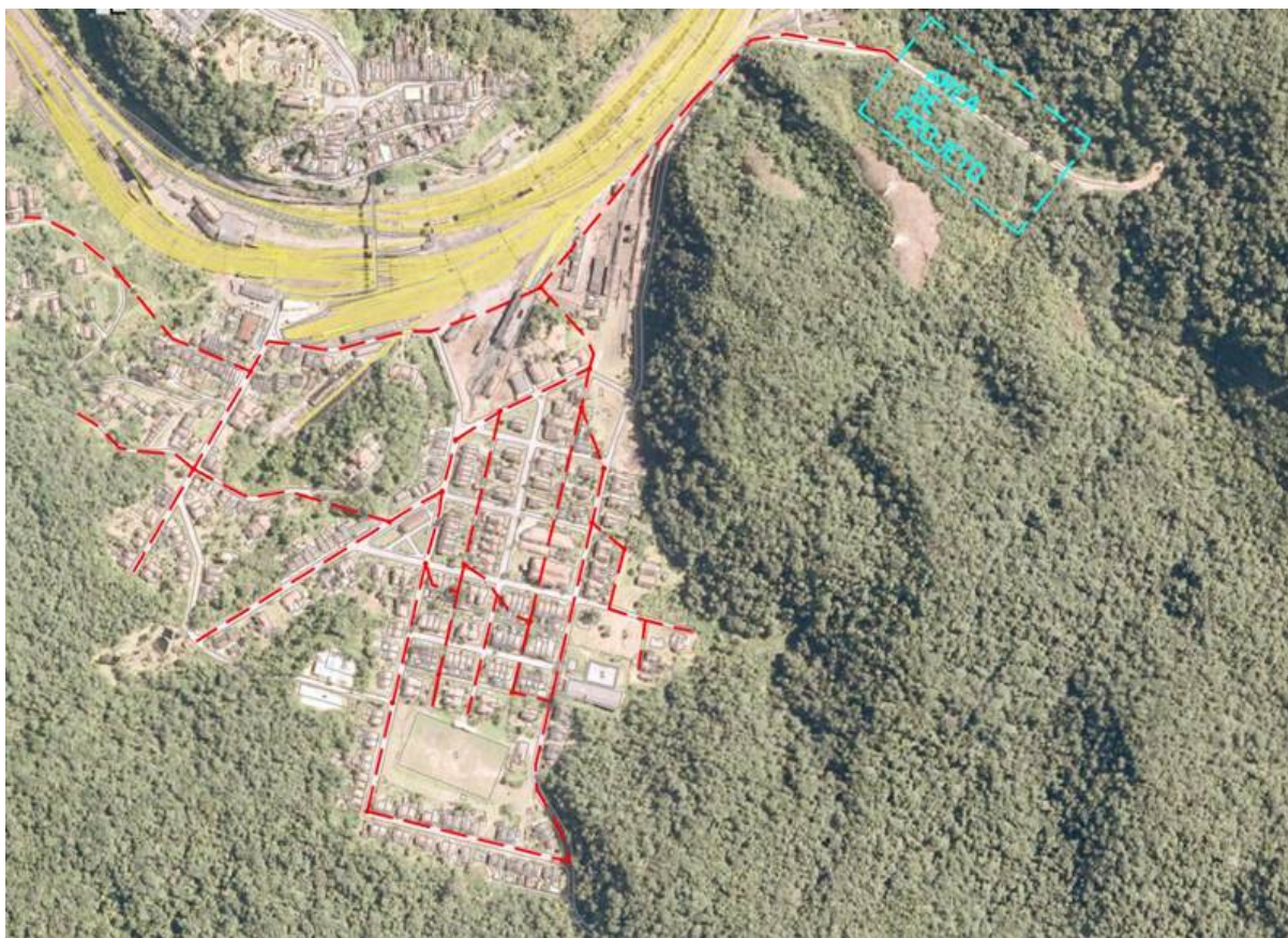
Figura 2: Rede de coleta de esgotos proposta.
