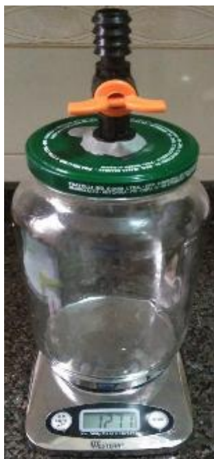
Figura 3: Biodigestor padrão pronto pesando 1271 g
