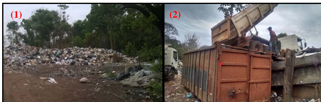
Figura 6: Estação de Transbordo em Santo Antônio. (1) Disposição de resíduos sem controle ambiental. (2) Contêiner para armazenar os resíduos para possível traslado para o aterro sanitário.
