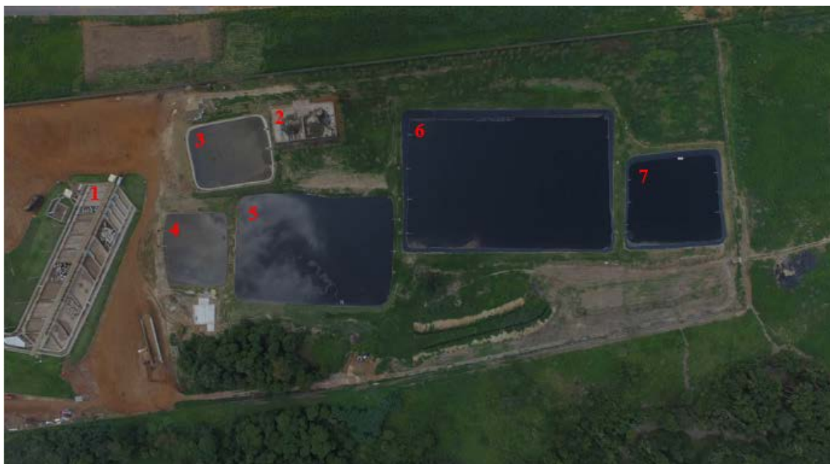
Figura 02 - Curral de espera e arranjo do sistema de tratamento da indústria. (1) Curral de espera; (2) leito de secagem; (3) lagoa anaeróbia; (4) lagoa anaeróbia; (5) lagoa anaeróbia; (6) lagoa facultativa; (7) lagoa de polimento.
