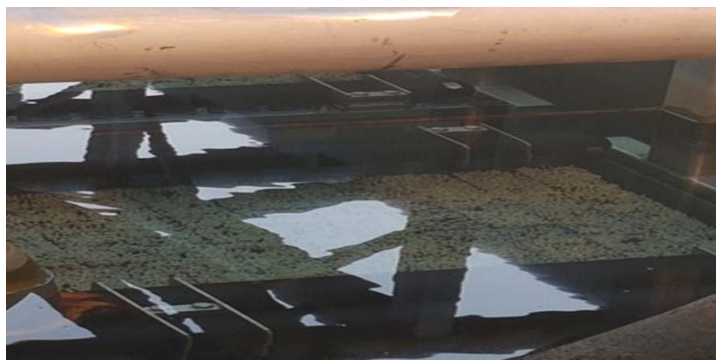
Fotografia 2- Skid com membranas submersas em água decantada
