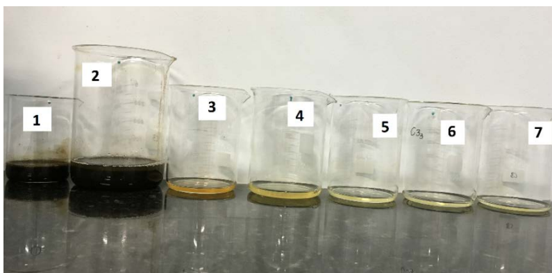
Figura 3 - Aspecto de clarificação do drenado do geotêxtil após o ensaio do Teste do Cone nos intervalos de: 1) 0; 2) 0 a 5; 3) 5 a 10; 4) 10 a 20; 5) 20 a 30; 6) 30 a 45 e 7) 45 a 60 minutos.
