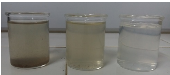
Figura 3: Efluente bruto (esquerda), efluente tratado por EF (centro) e efluente tratado por EC (direita).
