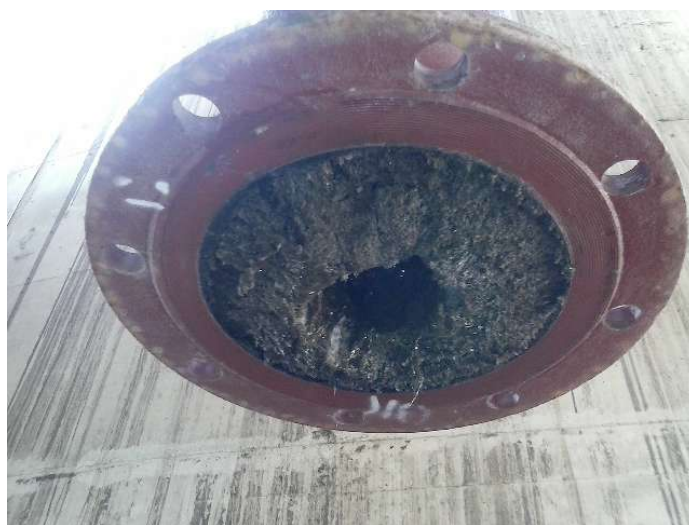
Figura 3: Foto da estruvita na tubulação de transferência lodo entre digestores
