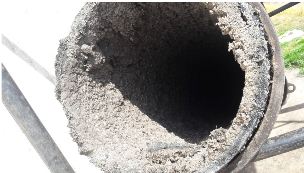
Figura 4: Foto da estruvita na tubulação de clarificado da centrífuga
