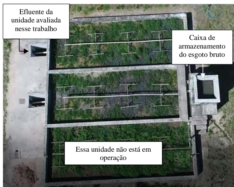
Figura 3 - Estação de tratamento de efluentes experimental localizada na ETE Arrudas. Fonte: Salim (2017).
