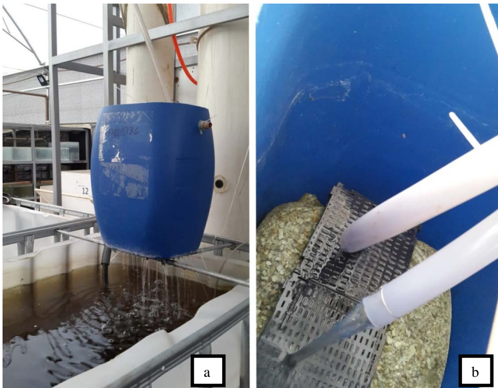
Figura 6. Filtro com pedra zeólita, vista externa (a) e interna (b).
