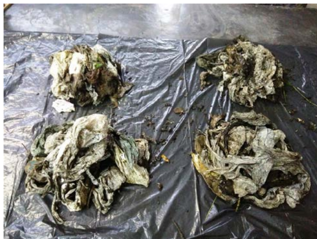
Figura 4: Quarteamento da amostra
