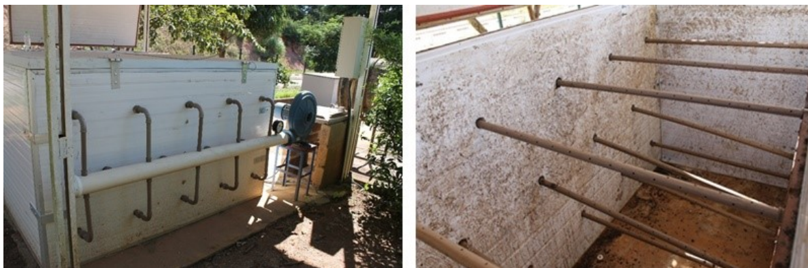
Figura 2 – Vista interna e externa dos tubos de aeração utilizados no biocompostador
