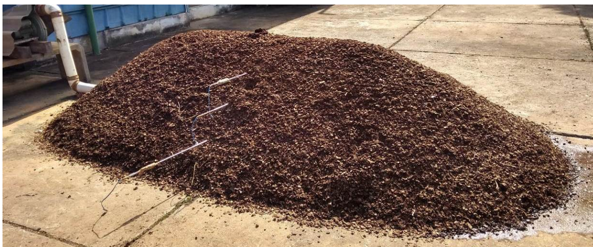
Figura 1 – Leira Estática aerada sobre tubo de aeração, coberta com camada de composto maturado e com a disposição das sondas de temperatura.
