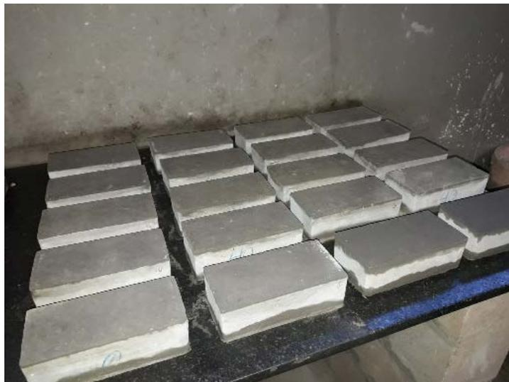
**Figura 7 – Capecamento nas duas faces do bloco**
