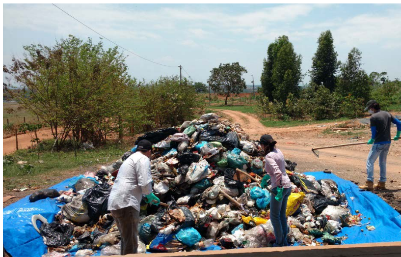
Figura 2 - Rompimento das embalagens dos resíduos e homogeneização.
