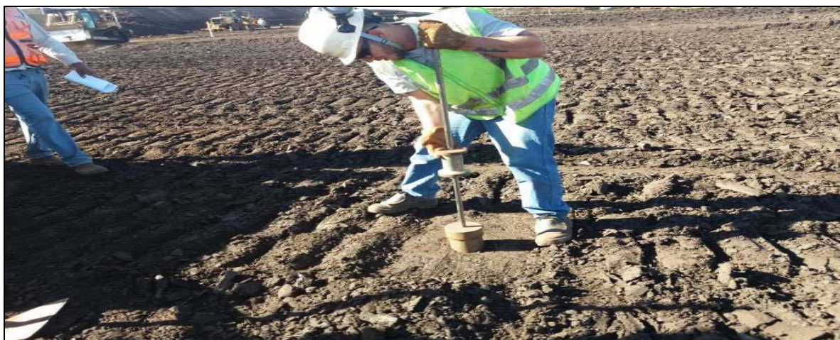
Figura 4: Acompanhamento do ensaio de compactação.
