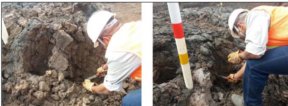
Figura 3: Acompanhamento de coleta para ensaio de umidade.
