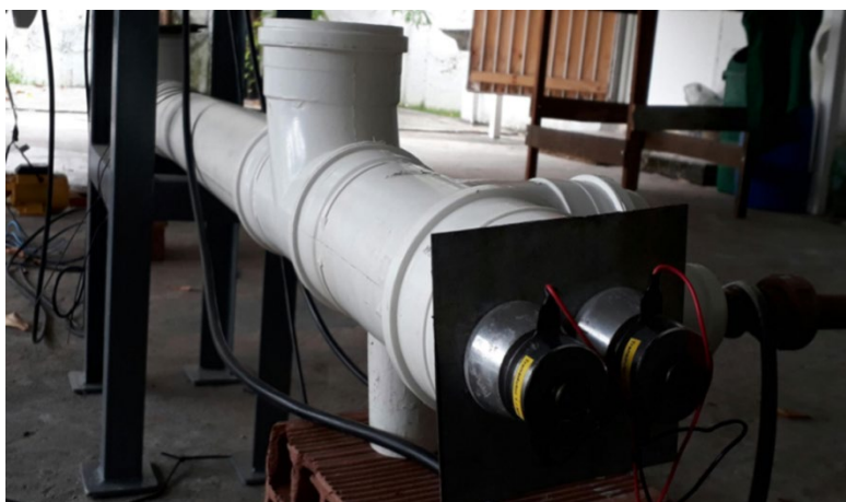
Figura 5 - Tubulação de 100 milímetros e arranjo utilizado para experimentos. Fonte: Própria.
