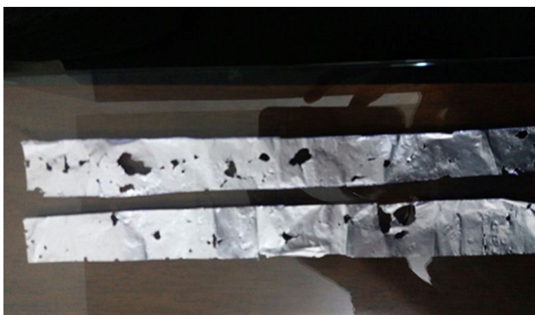
Figura 6 - Danos causados pelo fluxo de água onde ocorria cavitação sônica produzido por transdutores de 50 W a uma frequência de 35 kHz. Fonte: Própria.
