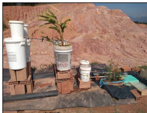
Figura 4 - Sistema de tratamento com os WCs e sistema de controle
