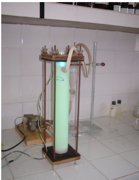
Figura 1 – Reator de Tubos Concêntricos
