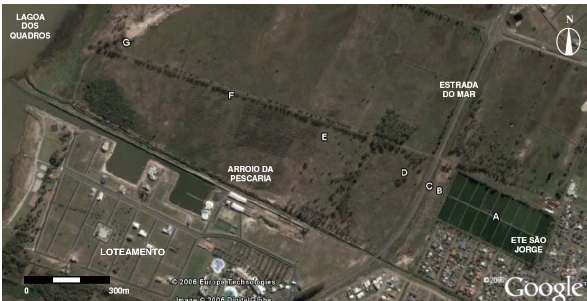
Figura 2: Loteamento em Capão da Canoa – RS, próximo da ETE São Jorge (CORSAN), com piezômetros de monitoramento A à G.
