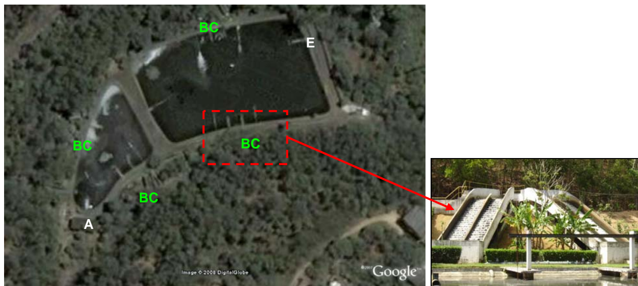
Figura 1: Vista geral da ETE Serra Dourada, localização dos pontos de coleta e detalhe do bioaerador de cascata. (A) afluente, (E) efluente e (BC) bioaerador de cascata.
