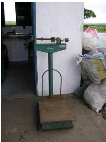
**Figura 2 – Balança da usina de reciclagem, utilizada na caracterização física dos RSU**
