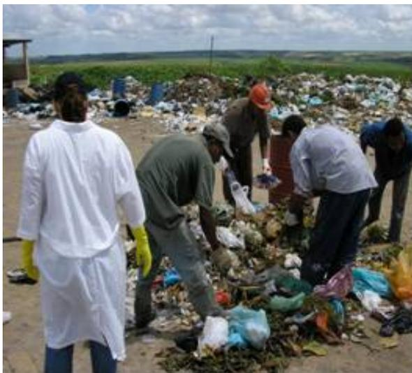
**Figura 1- Separação manual dos RSU**
