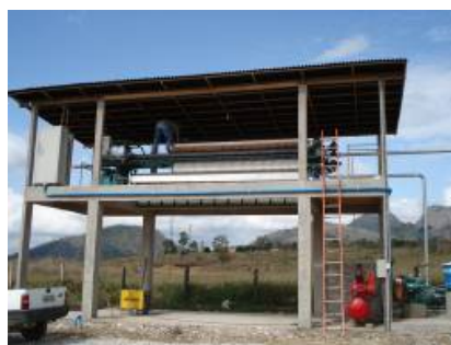
Figuras 8 e 9 - Sistema de Desidratação Sedimentador e Filtro-prensa
