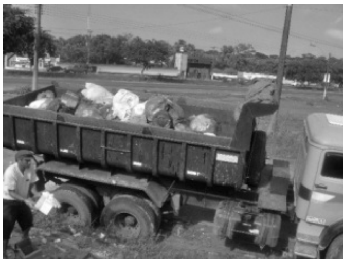
Figura 1: Transporte de resíduos de saúde inadequado de acordo com a norma NBR 14.652. Veículo coletor de resíduo sem identificação, aberto, sem Equipamento de Proteção individual e Coletiva.
