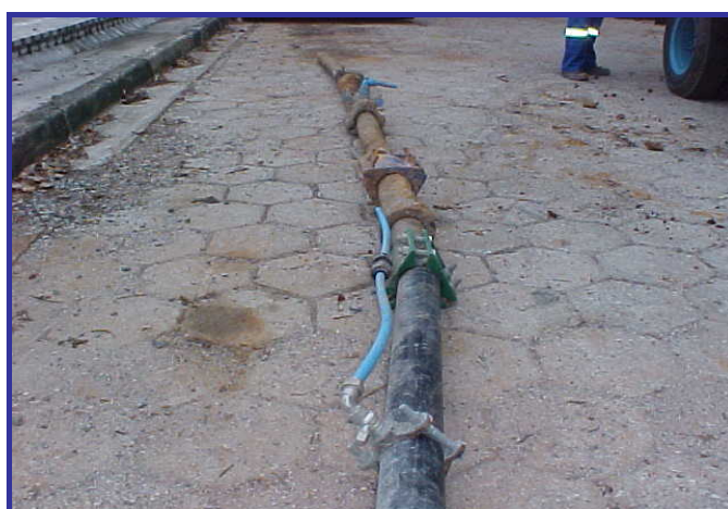
Figura 3: Foto de rede de água com vários arrebitamentos
