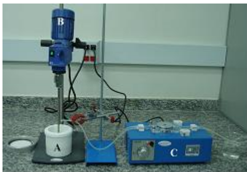
Figura 3: Sistema utilizado na síntese da hidrotalcita. Reator (A), agitador mecânico (B) e bomba peristáltica (C).
