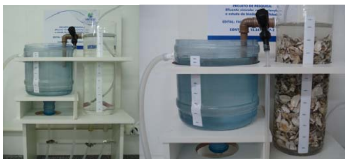
Figura 3: Biofiltro Aerado Submerso utilizado no tratamento de efluente vinícola no período de entressafra ainda preenchido com água.
