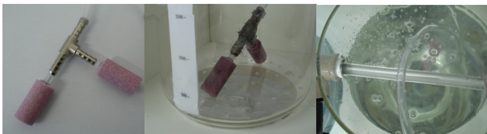
Figura 2: Detalhe das pedras porosas utilizadas, do fundo falso do reator e da canaleta de coleta.
