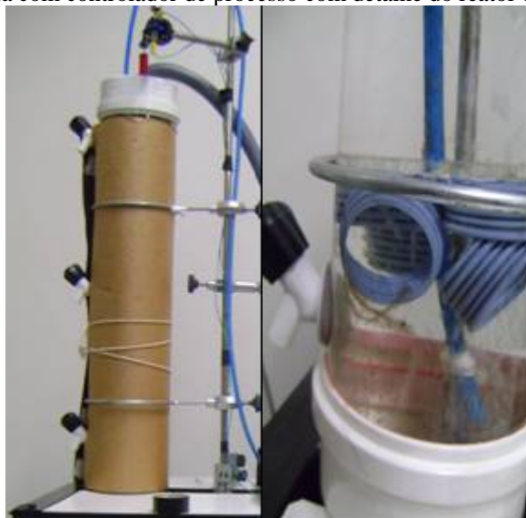
Figura 1: Reator em batelada com controlador de processo com detalhe do reator de acrílico e o meio suporte.
