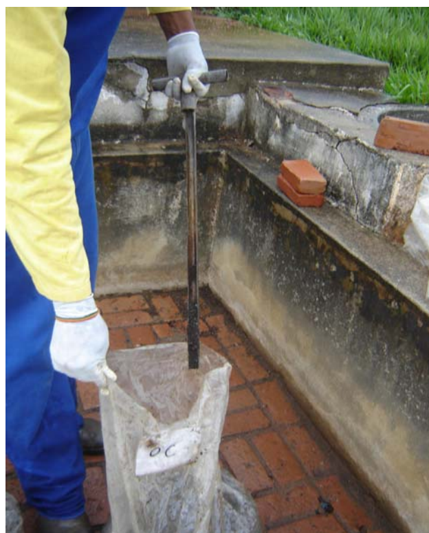
Figura 2: Coleta de lodo com o amostrador “Trier”
