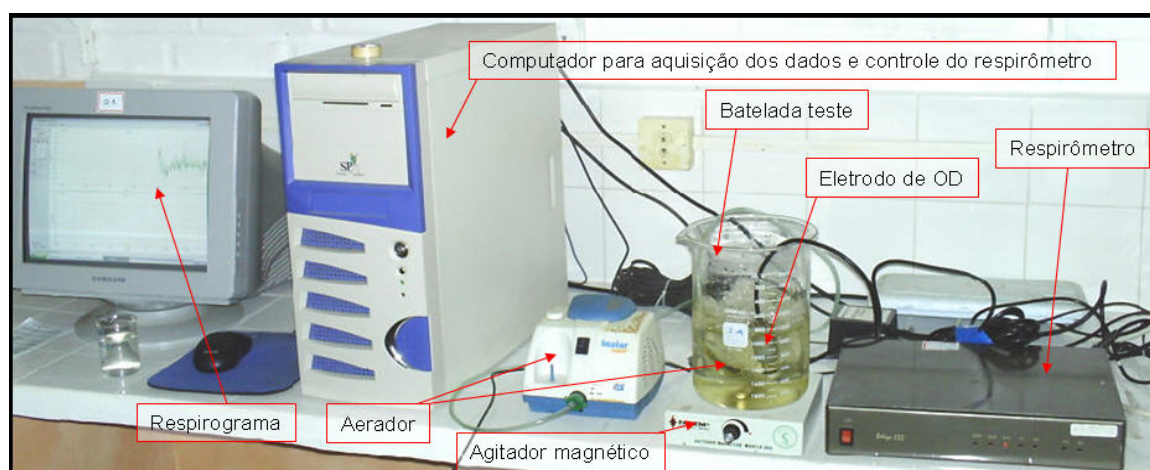
Figura 3: Equipamentos necessários para a realização dos testes respirométricos com o lodo gerado nos reatores Bardenpho e UCT
