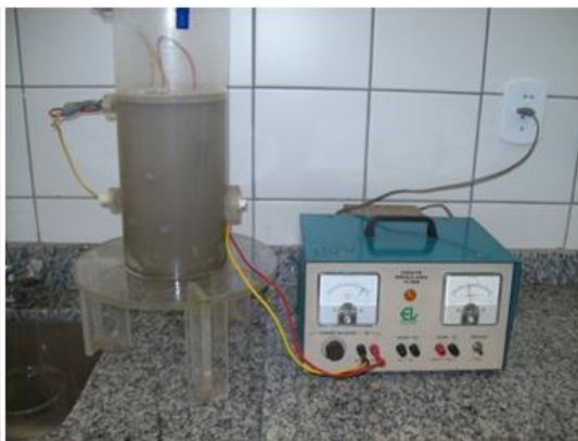
Figura 2: Reator em funcionamento e fonte de alimentação
