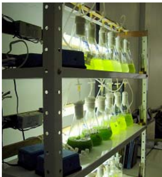
Figura 1 – Sistema de bancada para fotobiorreator estacionário.
