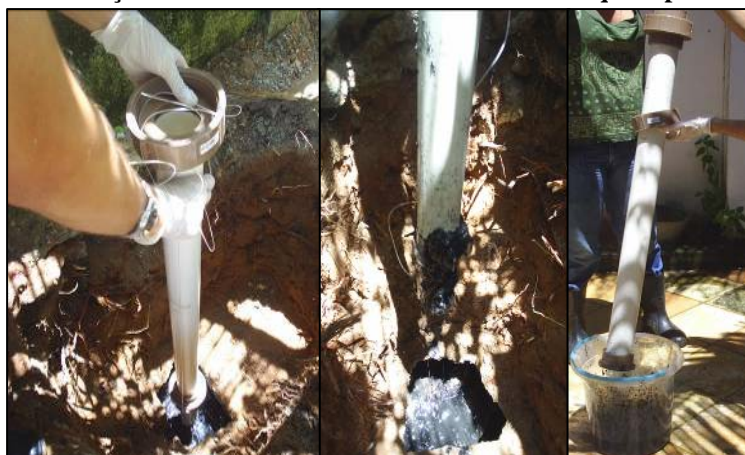
Figura 2: Introdução do amostrador em uma câmara de tanque séptico residencial.
