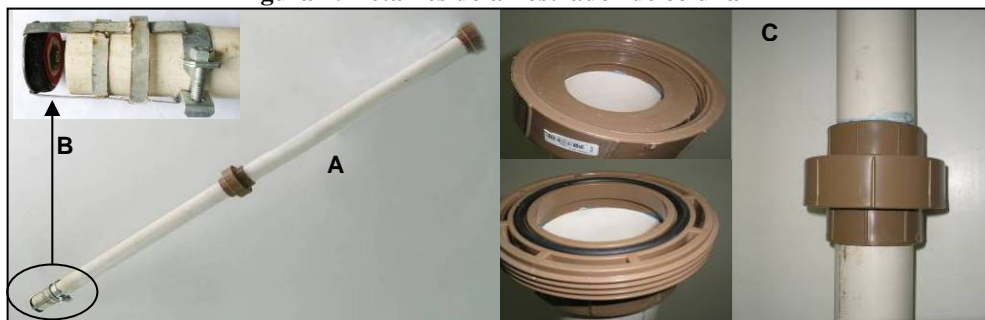
Figura 1: Detalhes do amostrador de coluna
