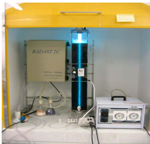
Figura 1: Unidade de Fotoozonização. Volume útil de 10 Litros.
