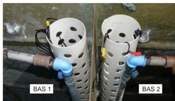
Figuras 2: Coletor posicionado dentro dos reatores - biofiltros 1 e 2.
