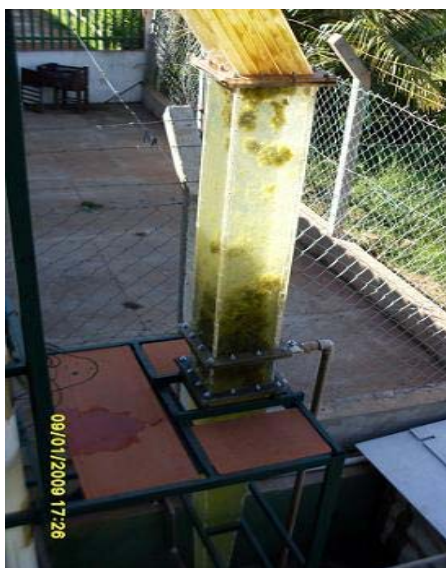
Figura 13: Manta sendo desfeita e carregada para o decantador
