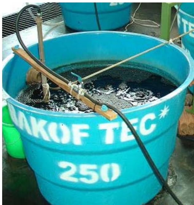
Figura 2: Sistema de tratamento biológico do tipo lodos ativados em batelada em escala piloto (tanque de 250L).
