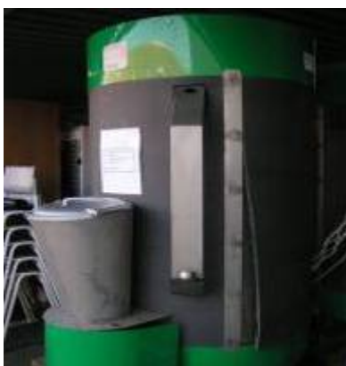
Figura 1: Foto do reator de aerção forçada de fluxo ascendente
